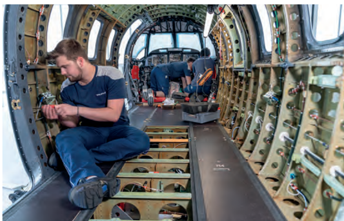
^ Montaggio, cablaggio e collegamento Questi professionisti e queste professioniste effettuano il cablaggio dei cavi con un cacciavite.
