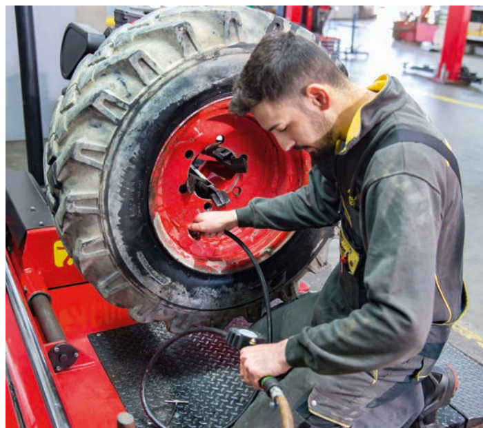
▼ Controllo della pressione di un pneumatico.
