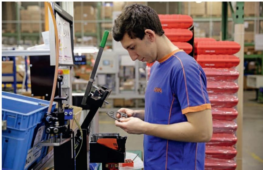
completa il bilanciante con i rulli guida e la molla ghiera, poi lo mette sul nastro trasportatore con altri pezzi che ha preparato. Il prodotto prosegue verso la postazione di lavoro successiva, dove al bilanciante vengono assemblati altri pezzi fino a formare l'apparecchio finito.
