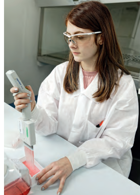
^ Fabienne distribuisce la soluzione nutritiva utilizzando pipette ad alta precisione.
