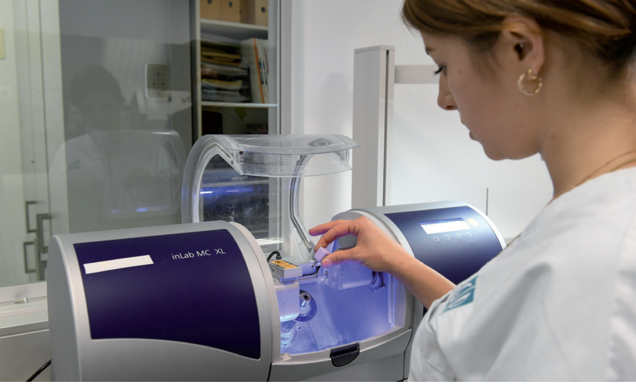
◀ L'apprentie se sert d'une fraiseuse pour meuler une couronne.
