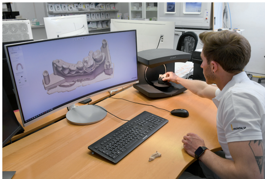
^ Les empreintes dentaires peuvent être numérisées au moyen d'un scanner 3D.
