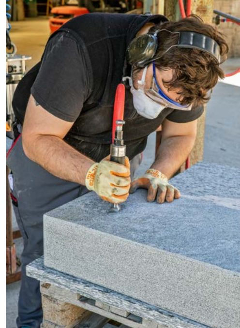
^ Raul Pollini utilise le marteau pneumatique pour donner à la surface de la pierre une structure rugueuse.
