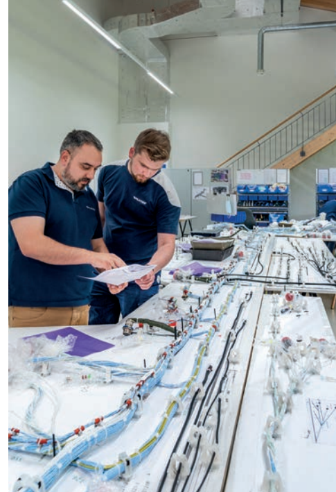
À l'atelier, Manuel Giese et ses collègues assemblent les câbles électriques en faisceaux.
