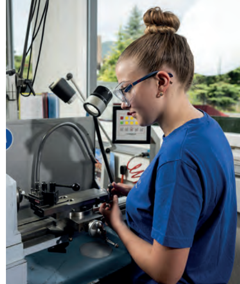
Le travail au tour permet de créer une pièce d'une grande précision à partir d'un cylindre métallique.
