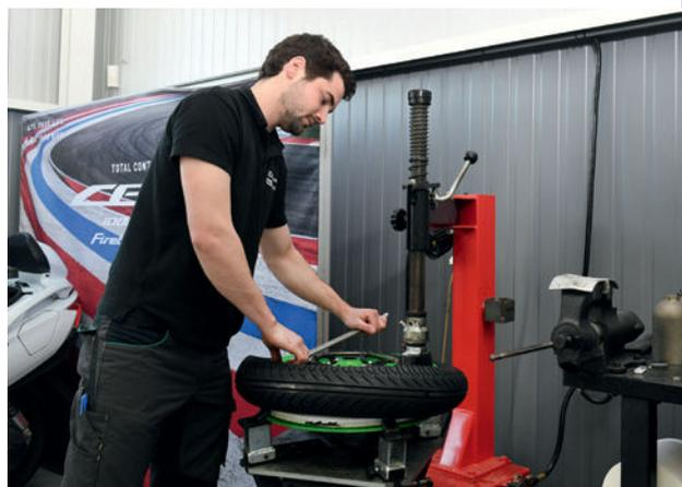
^ **Changement de pneus** Les pneus usés sont changés. Après avoir équilibré et remonté les roues, les mécaniciens et mécaniciennes en motos vérifient la pression de l'air.
