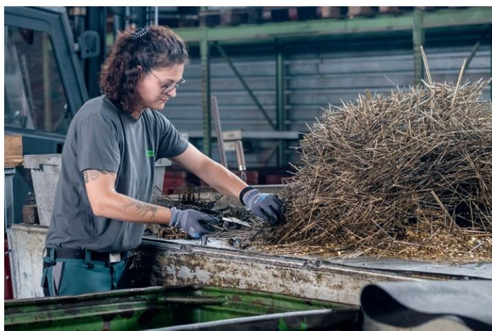
^ **Broyage** Pour être recyclés, les métaux doivent être réduits en petits éléments avant d'être envoyés à la fonderie. Les grandes pièces sont découpées à l'aide d'un chalumeau ou de cisailles.
