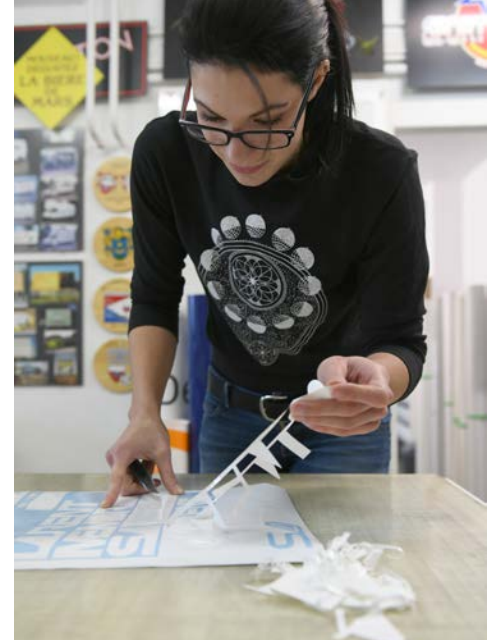
^ Le dépouillage consiste à retirer le surplus de matière autour des lettres ou d'un logo.
