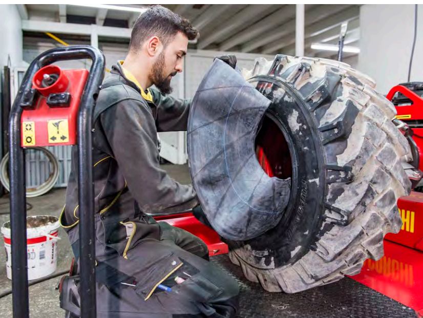
▼ Remplacement de la chambre à air.
