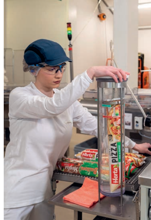
^ Mirdona Sylaj trempe l'emballage dans l'eau pour vérifier qu'il est imperméable.
